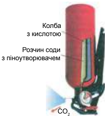
Мал. 72. Кислотний вогнегасник у дії
